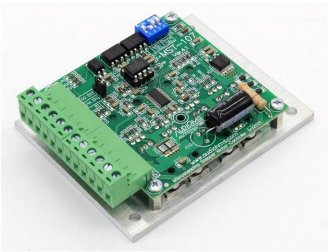
MST-107 je mikrostep drajver za koračne motore sa maksimalnim naponom napajanja 40V i za maksimalnu struju od 7,5 A po fazi.
