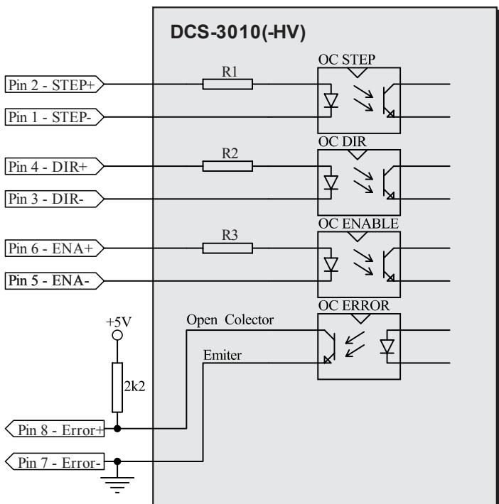
Slika 4.2 Shematski prikaz opto-izolovanih ulaza i izlaza
