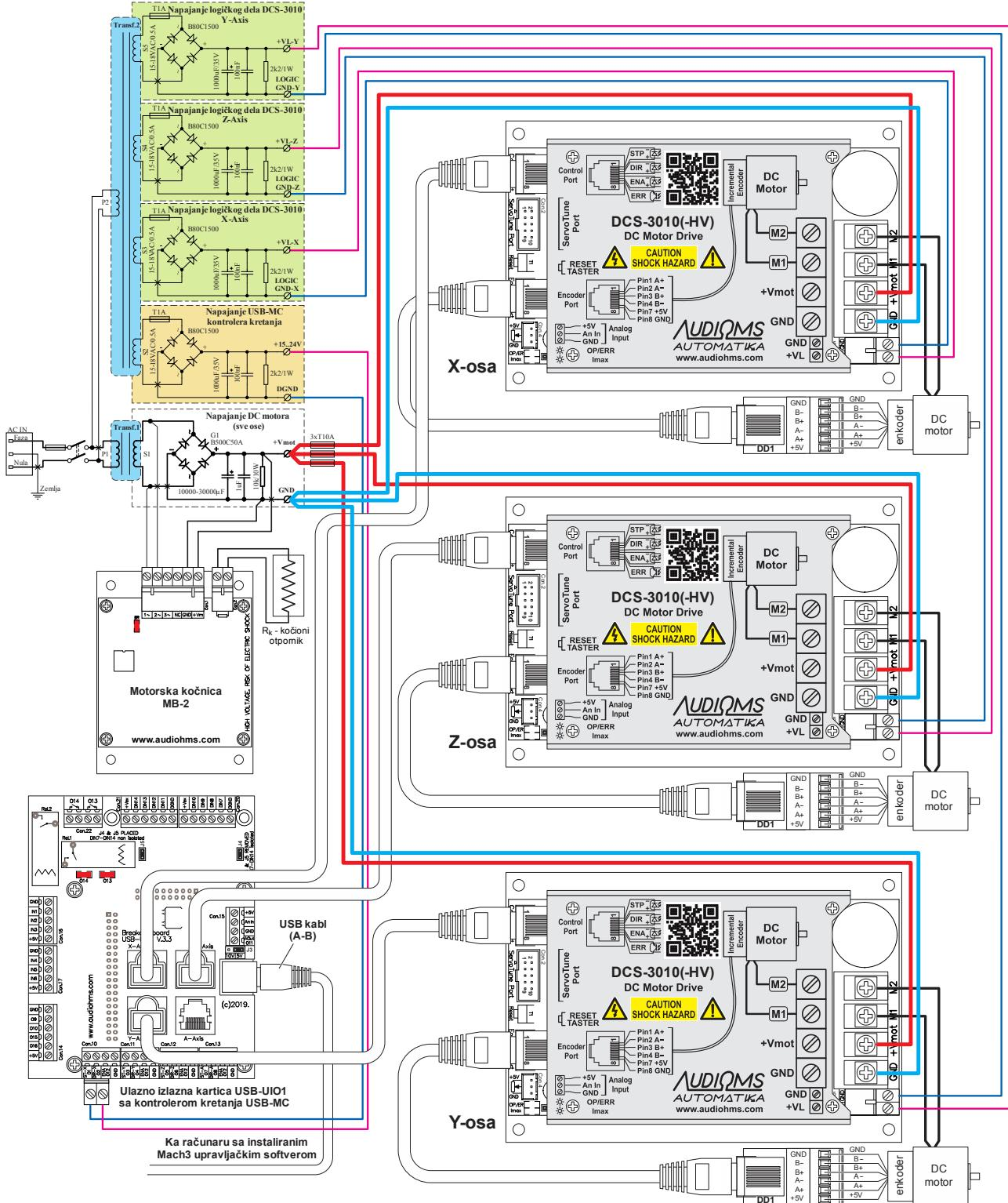
Slika 4.7 Veza USB-MC kontrolera kretanja, ulazno-izlazne kartice USB-UIO1 v3.3, motorske kočnice MB-2 i tri DC servo drajvera DCS-3010(-HV)
