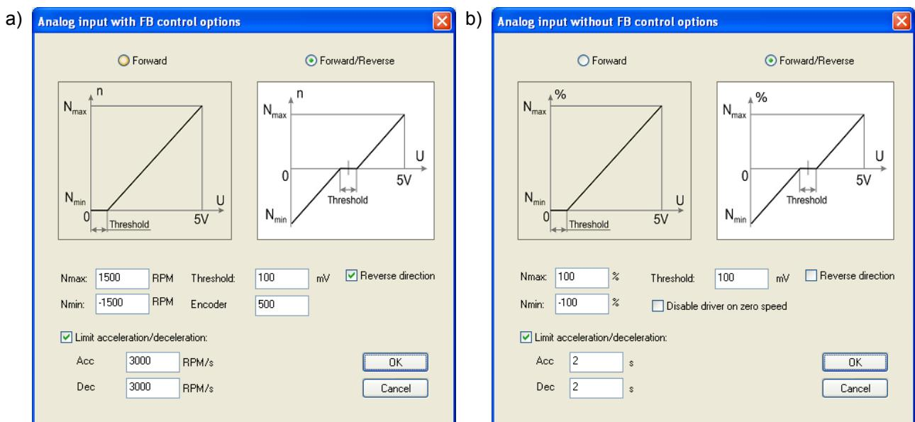
Slika 8.8 Dijalog za podešavanje parametara, a) analognog ulaza sa povratnom spregom i
