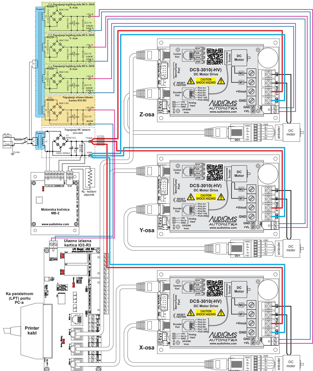
Slika 4.8 Veza ulazno-izlazne kartice IO3-R3, motorske kočnice MB-2 sa tri DC servo drijvera DCS-3010(-HV)
