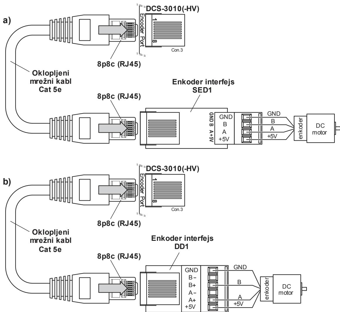
Slika 4.3 Povezivanje inkrementalnog enkodera sa nesimetričnim (single-ended) izlazima na DC servo drajver DCS-3010(-HV) preko, a) SED1 enkoder interfejsa i b) DD1 enkoder interfejsa
