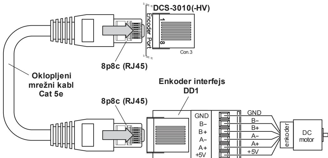
Slika 4.4 Povezivanje inkrementalnog enkodera sa diferencijalnim (komplementarnim) izlazima preko DD1 enkoder interfejsa na DC servo drajver DCS-3010(-HV)
