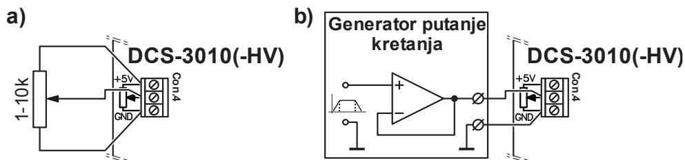
Slika 4.5 Generisanje naponske reference na analognom ulazu DC servo drajvera DCS-3010(-HV) preko,
